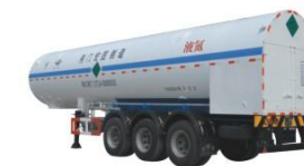
液氮运输半挂车 LN 2 semi-trailer
