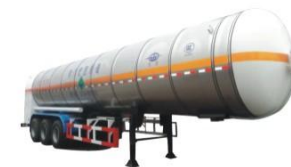
液态二氧化碳运输半挂车 LCO 2 semi-trailer
